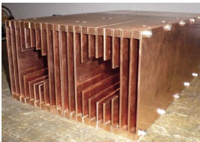
Abbildung 1: Rippenkonstruktion des Wärmetauschers aus Kupfer.
