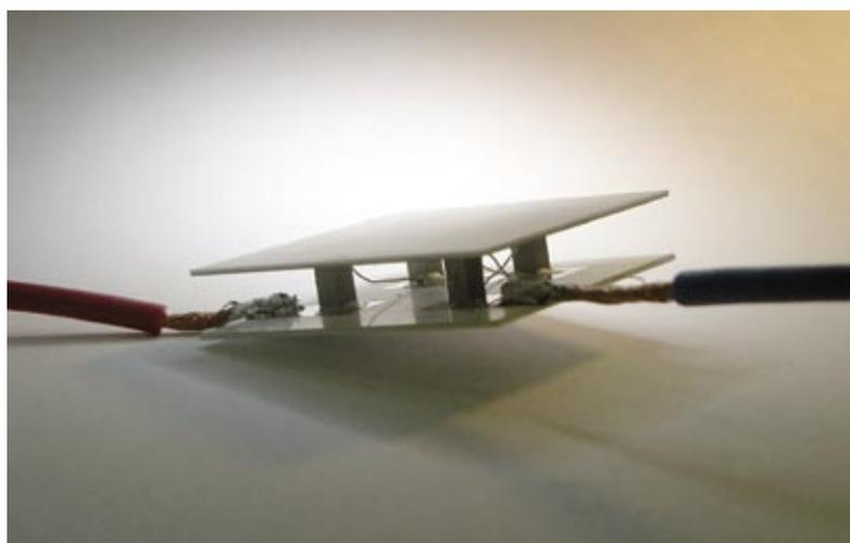
Abbildung 2: „Thermoelectric Oxide Module“ TOM.
